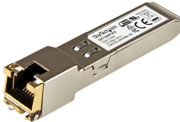
Der SFP1000TXST ist ein MSA-konformer Kupfer-SFP-Transceiver, der für die Arbeit mit 1000BASE-TX-kompatiblen MSA-Switches und -Routern entwickelt, programmiert und getestet wurde. Das SFP-Transceiver-Modul unterstützt eine maximale Entfernung von bis zu 100 m und bietet zuverlässige 1-GbE-Konnektivität über Kupferkabel. **Technische Daten:**
