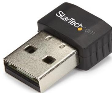
Dieser USB Wi-Fi®-Adapter fügt Ihrem Laptop, Tablet- oder Desktop-Computer Dual-Band-Wireless-Konnektivität hinzu und bietet einen kompakten Formfaktor in Nanogröße. Mit Zugang zu sowohl 2,4 GHz- als auch 5 GHz-Wi-Fi®-Netzwerken vereinfacht er den Austausch oder die Erweiterung der bestehenden Wireless-Funktion Ihres Computers.
