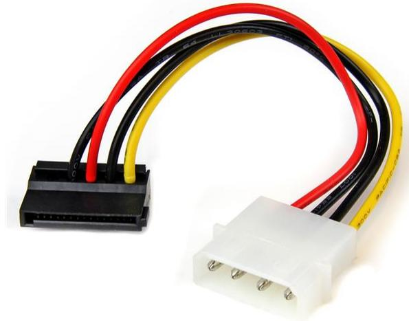
Dieser Molex-auf-90-Grad-SATA-Netzadapter SATAPOWADPL hat einen 4-poligen LP4-Stecker und einen linksgewinkelten 90-Grad-SATA-Netzanschluss (Buchse), mit der Sie eine Serial ATA-Festplatte über einen herkömmlichen LP4-Anschluss mit Strom versorgen können. So sparen Sie die Aufrüstung der Computerstromversorgung für Kompatibilität mit der SATA-Festplatte.
