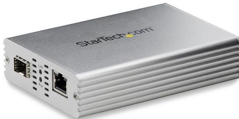
Dieser Ethernet-Glasfaser-Medienkonverter bietet eine einfache, kostengünstige Möglichkeit zur Erweiterung Ihres Netzwerks über Glasfaser mit dem SFP+ Ihrer Wahl. Er wandelt eine Kupfer-RJ45-Ethernet-Verbindung zu 10-Gigabit-Glasfaser um, um Ihr Netzwerk über größere Entfernungen zu erweitern oder Workstations mit Switches zu verbinden.
