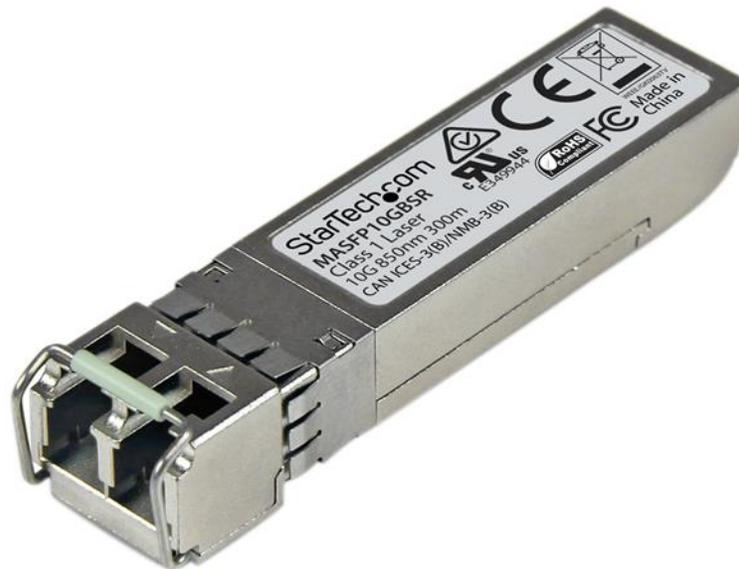
Das MASFP10GBSR ist ein Cisco Meraki MA-SFP-10GB-SR-kompatibles Glasfaser-Transceiver-Modul, das speziell für die Zusammenarbeit mit Cisco Meraki™-Switches und -Routern entwickelt, programmiert und getestet wurde. Es liefert zuverlässige 10-GbE-Konnektivität über Glasfaserkabel für 10GBASE-SR-konforme Netzwerke mit einer maximalen Entfernung von bis zu 300 m.
