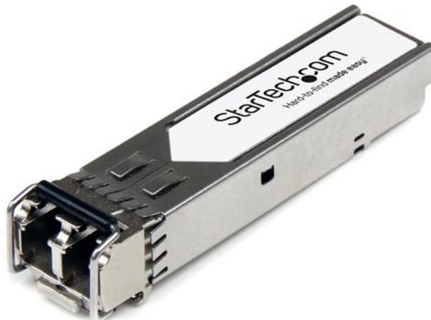
Der SFP-10G-ZR-ST ist ein Cisco SFP-10G-ZR-kompatibles Glasfaser SFP+-Transceiver-Modul, das für den Einsatz mit Cisco® Marken-Switches und -Routern entwickelt, programmiert und getestet wurde. Es sorgt für zuverlässige 10 GbE-Konnektivität über Glasfaser-Kabel für 10GBase-ZR-konforme Netzwerke mit einer maximalen Entfernung von bis zu 80 km.
