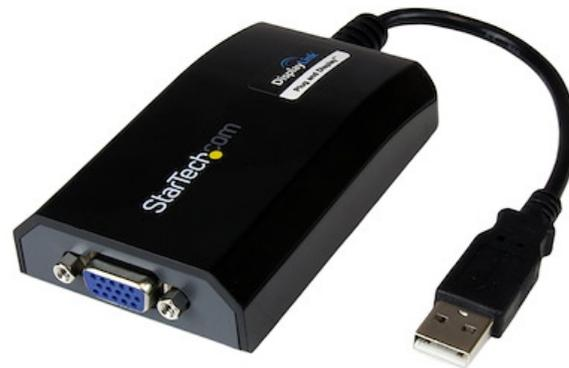
Der USB2VGAPRO2 USB auf VGA-Adapter dient als externe Grafikkarte für Windows® und Mac® Computer - die perfekte Lösung, um Ihren Desktop oder Laptopcomputer in eine Umgebung mit zwei oder mehreren Monitoren zu verwandeln, durch die Einfachheit und die Bequemlichkeit des USB.
