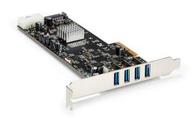
Mit der 4-Port-PCI Express-USB 3.0-Karte PEXUSB3S44V können Sie einem PCIe x4-fähigen PC vier dedizierte 5-Gbit/s-USB 3.0-Ports hinzufügen. Diese Architektur mit unabhängigen Ports verbessert die USB 3.0-Leistung durch Übertragen von Daten auf vier einzelnen Kanälen an den Computer, sodass die Dateiübertragung schneller erfolgt. <br/>
