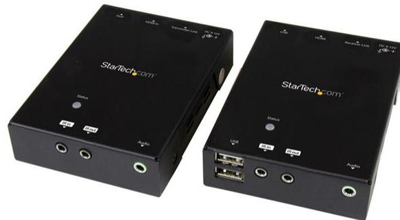
Dieses HDMI- Extender -Kit verwendet HDBaseT 2.0-Technologie, sodass Sie 4K HDMI-Video und vier USB 2.0-Peripheriegeräte an einen Remote-Standort in bis zu 90 Metern Entfernung über ein einziges CAT5e- oder CAT6-Kabel erweitern können. Der Extender kann 1080p (HD) Video sogar noch weiter bis zu 100 Metern erweitern.
